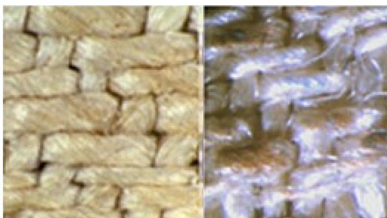
Figura 17. Microfotografie di fili di immagini (diametro di circa 0,25\ \text{mm} ): ST (a sinistra, © B. Schwartz) ed esperimento di Garlaschelli (a destra), con evidenti laghi di colore (Rif. 27).
