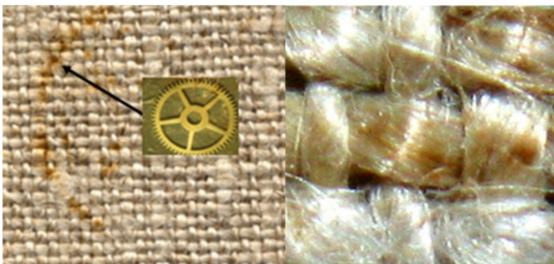
Figura 18. Tessuto di lino colorato da EC, prodotto da una ruota di orologio in bronzo (diametro di circa 10 mm) posta su una sfera al plasma. Immagine della ruota (a sinistra) e dettaglio dell'immagine, che mostra le striature tipiche (destra) (Rif. 1).
