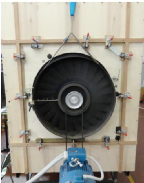
*Vista frontale del ventilatore di 0,8 m durante il test. Si noti la flow visualization tramite tufts, a sinistra.*
